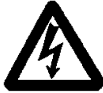
Gevaar voor elektrische spanning
